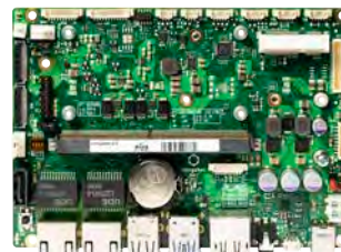
conga-SMC1/SMARC-ARM 支持基于ARM架构 SMARC2.0模 块的载板
