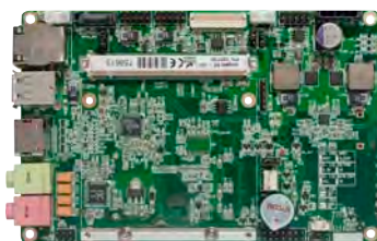
conga-MCB/ARM 小尺寸(95x140mm)载板, 支持 基于ARM的Qseven 模块
