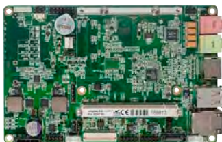
conga-MCB/Qseven 小尺寸(95x140mm)载板, 支持 基于x86的Qseven 模块
