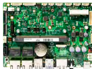
conga-SMC1/SMARC-x86 支持基于x86架构 SMARC2.0模块的 载板
