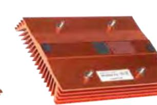
最大で 20 mm の高さに収まる、Thin Mini-ITX 規格に完全準拠したソリューション用アクティブ冷却システム。高い信頼性のサーボ制御ファン。CPU に最良の熱接点を提供するリーフスプリング。熱移送を最適化するために実装されたフェイズチェンジマテリアルは、最高のターボブースト性能を可能とします。また、ボードの背面に実装されたリテンションフレーム付き固体により、高い衝撃と振動耐性を実現します。
