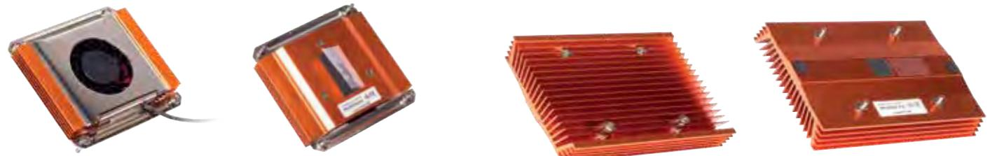
最大で 20 mm の高さに収まる、Thin Mini-ITX 規格に完全準拠したソリューション用アクティブ冷却システム。高い信頼性のサーボ制御ファン。CPU に最良の熱接点を提供するリーフスプリング。熱移送を最適化するために実装されたフェイズチェンジマテリアルは、最高のターボブースト性能を可能とします。また、ボードの背面に実装されたリテンションフレーム付き固体により、高い衝撃と振動耐性を実現します。
