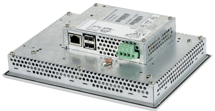
Bild 1: Der Rahmen ist nur geringfügig breiter als der Einbauausschnitt
