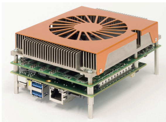
Figure 1: High-End Performance auf nur 125 x 95 mm: conga-TR3 Computermodul mit aktiver Heatpipe Kühlösung montiert auf einem Carrierboard.
